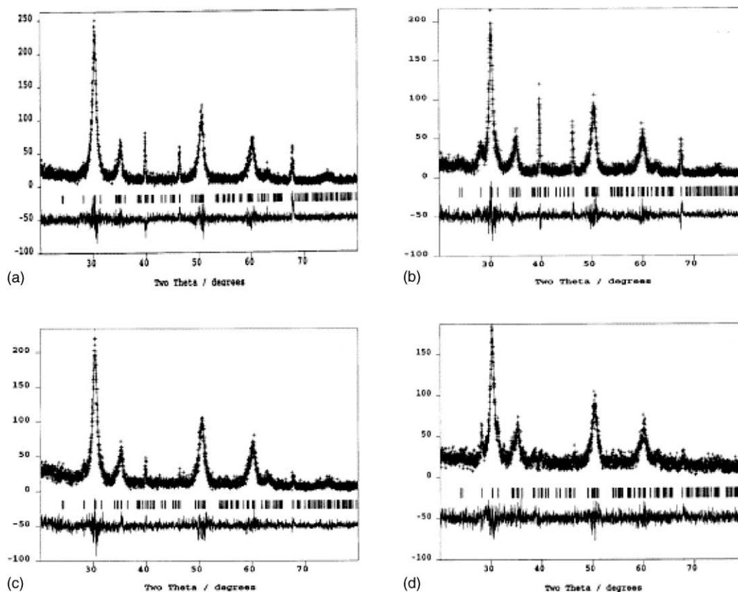
Fig. 2. Rietveld refinement plots (a)  $\text{CuZr}_2$ , (b)  $\text{CuZr}_5$ , (c)  $\text{CuZr}_{10}$ , (d)  $\text{CuZr}_{20}$  samples scanned at 303 K.
