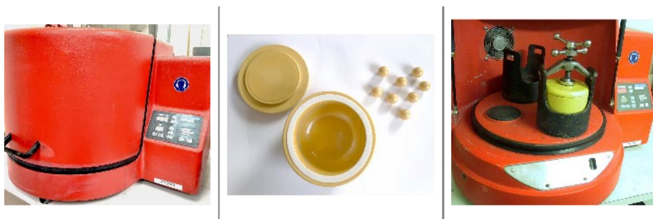
Figura 18. Molino planetario modelo Pulverisette 5, Fritsch GmbH. Jarra y bolas de zircona y su colocación en el interior del molino.
