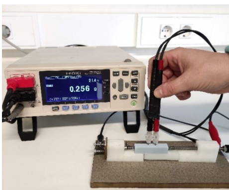
Figura 29. Equipo de medida de resistividad HIOKI, RM 3545 y soporte adaptado a las dimensiones de los electrodos para medir por el método de los cuatro puntos.
